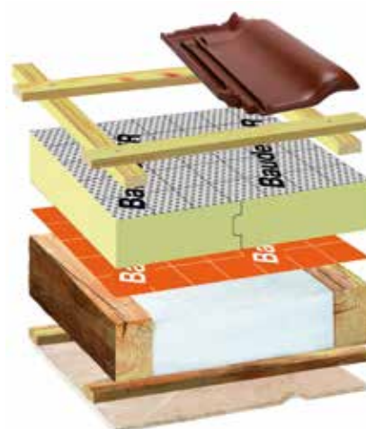
Beispiel 2: Hygrothermische Simulation nach DIN 4108 T3 Vollsparrendämmung mit waagrecht verlegter Luftdichter Schicht
