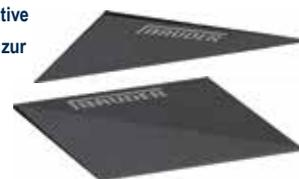
Beim Verlegen der BauderPIR FA Gefälledämmung ergibt sich im Kehl- bzw. Gratbereich ein Versatz. Um diesen zu „füllen“ werden die BauderPIR KFS Kehlfüllstücke und BauderPIR GFS Gratfüllstücke (orange markiert) eingebaut.
