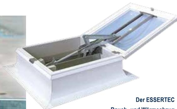
Der ESSERTEC Rauch- und Wärmeabzug fumulux® 4000-EAZ besteht aus Lichtkuppel, elektrisch gesteuerter Rauchabzugsmechanik und Aufsetzkranz. Er ist zugelassen nach DIN EN 12101-2. Seine 24V-Technik übernimmt im Brandfall – ausgelöst durch den Rauchmelder – die Öffnung der Lichtkuppeln.
