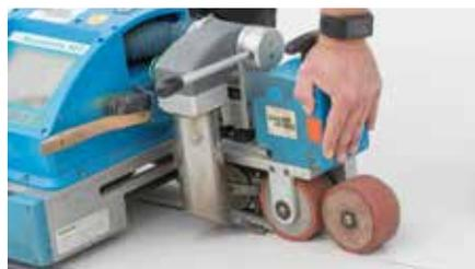
Der Schweißautomat Sarnamatic 661 verschweißt die FPO-Kunststoffbahnen und presst sie über die nachlaufenden Andrückrollen zusammen.
