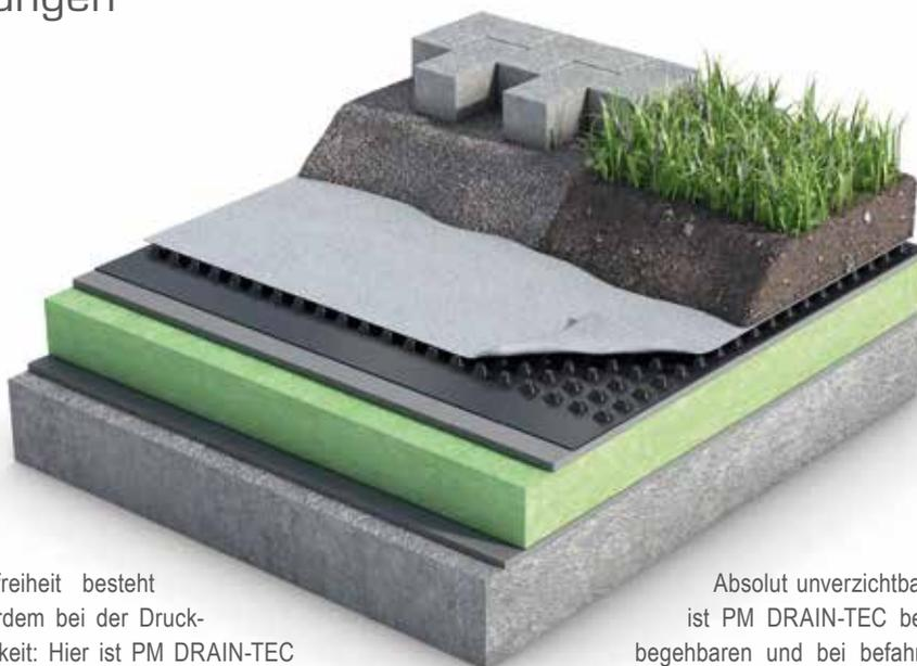
Wahlfreiheit besteht außerdem bei der Druckfestigkeit: Hier ist PM DRAIN-TEC in den Varianten 250 kN/m<sup>2</sup> und 400 kN/m<sup>2</sup> verfügbar. Damit bleibt die Noppenbahn in ihrer Schutz- und Drainagewirkung über alle Anforderungen besonders effizient und langlebig. Auf Wunsch ist sie zudem mit einer Perforierung auf der Rückseite erhältlich. So entsteht eine diffusionsfähige Drainagebahn, die auch auf Umkehrdächern zum Einsatz kommen kann.
