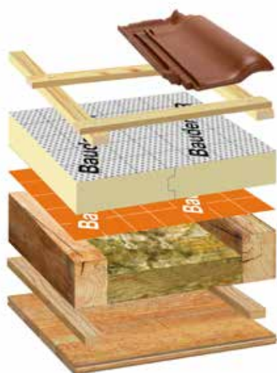
Beispiel 1: BauderPIR „+0“ oder BauderPIR „1:1“: Teildämmung zwischen den Sparren mit waagrecht verlegter Luftdichter Schicht
